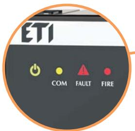
→ Индикация состояния контроллера, наличия информационного соединения, ошибок и аварийных ситуаций
